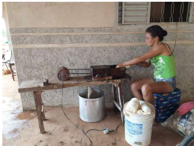
Figura 26: Trituração da mandioca e transformação em massa, município de Vazante. Fonte: Acervo Iepha-MG.
