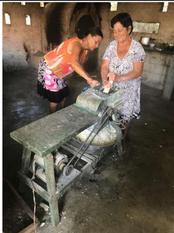
Figura 14: trituração da mandioca e transformação em massa. Fonte: Prefeitura de Araújo.
