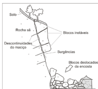
Figura 3.15 – Perfil esquemático do processo de queda de blocos.
