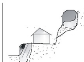
Figura 3.18 – Perfil esquemático de rolamento de bloco rochoso.
