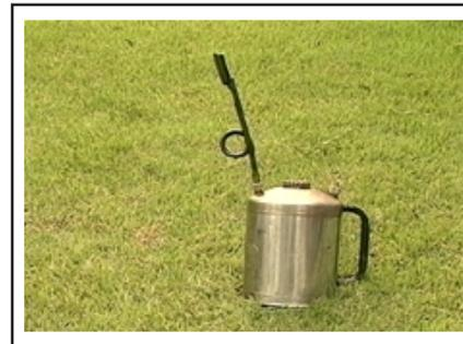
O conjunto é formado por um tubo com sistema anti-retorno que goteja sobre o queimador e permanece aceso durante o uso. A intensidade de gotejamento incandescente é feita através da válvula de ar.
