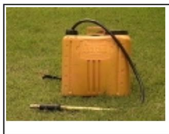
São depósitos de água, flexíveis ou rígidos com capacidade entre 18 a 20 litros, dotados de sistema de aspersão de água. Estes depósitos de água são transportadas como mochilas.
