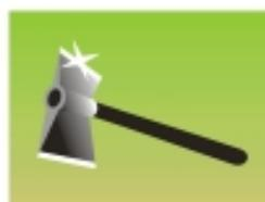
Manter as ferramentas afiadas. para afiá-las, deve-se evitar o uso do esmeril elétrico porque o calor destempera o aço, que vai perder o fio mais rapidamente. Para afiá-la utilize uma lima plana, fixada em uma bancada.
