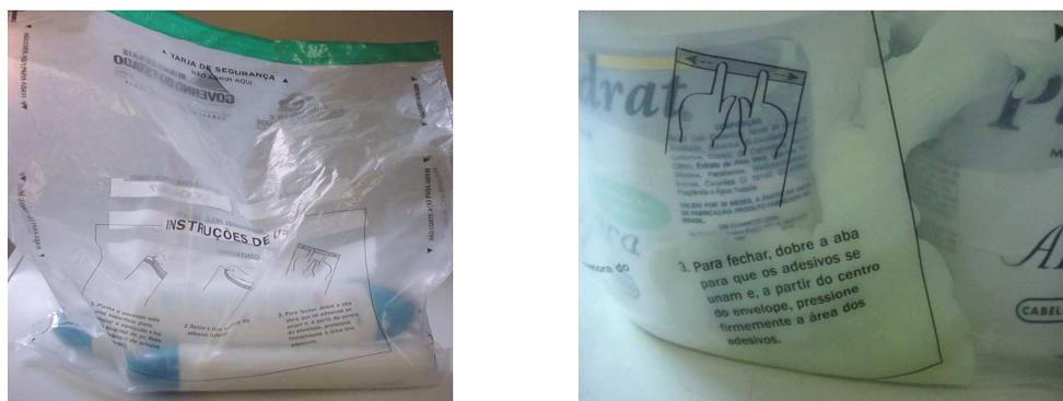
Figura 16: Amostras com acondicionamento incorreto
