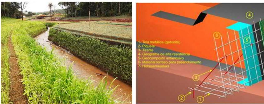
Figura 6.23. Proteção de margens com a técnica do sistema *Green Wall Water*®.
