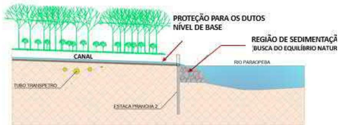
**Figura 5.10. Esquemático da solução de estabilização com a cortina de estaca prancha.**
