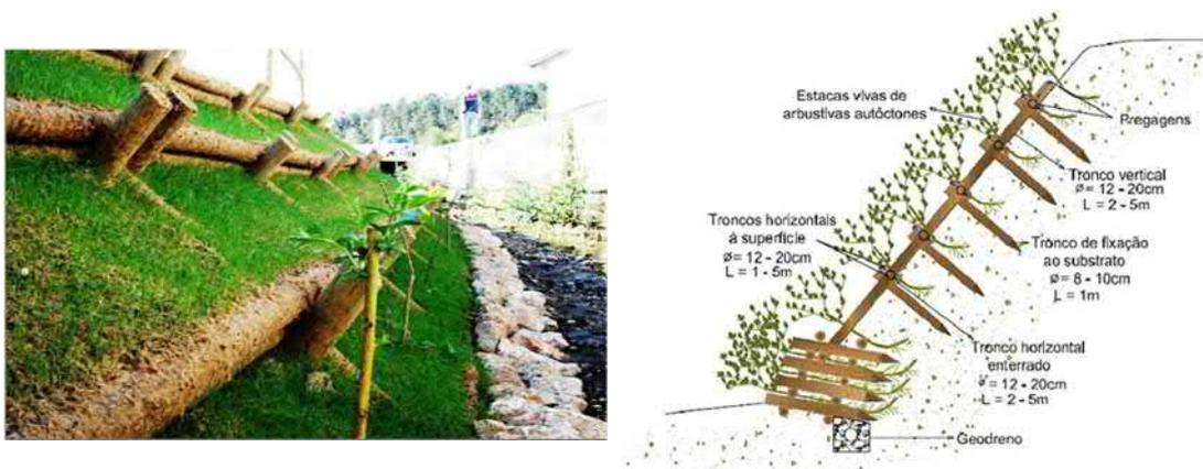
Figura 6.25. Proteção de margens com a técnica de grade viva.
