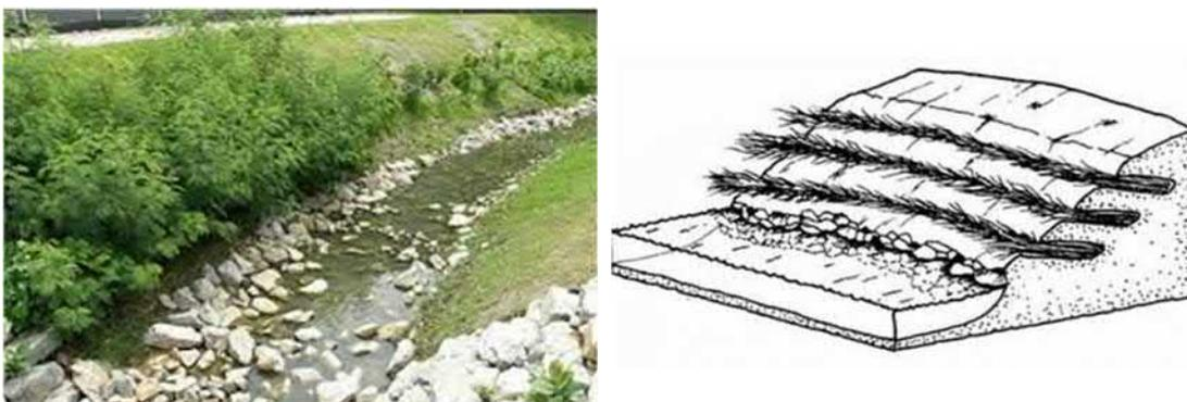
**Figura 6.12. Proteção de margens com a técnica de camada de ramos.**
