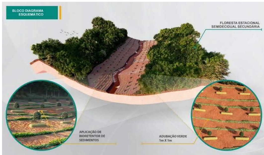
**Figura 6.30. Exemplo ilustrativo de plantio de mudas associado com adubação verde, após a remoção dos rejeitos, e com exemplo de aplicação de biorretentores ao lado de cada muda, em nível no terreno.**
